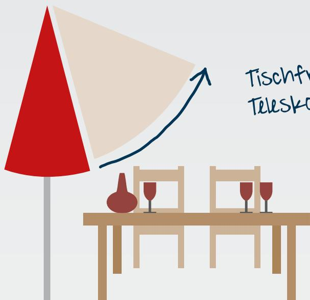
Dank dem Teleskop-Schiebesystem müssen beim Öffnen und Schließen Tische und Stühle nicht weggeräumt werden. Die Tischfreiheit beträgt ca. 85 cm.
