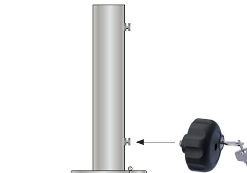
Diebstahlsicherung mit Schlüssel (optional): Handgriff fest anziehen, wenn Schlüssel abgezogen wird, lässt sich die Schraube nicht mehr öffnen.
