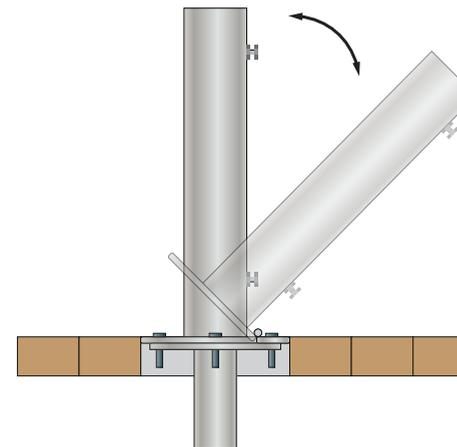
Schirm aufrichten und Kippadapter-Platte mit weiteren 3 Schrauben am Bodenrohr fest verschrauben.
