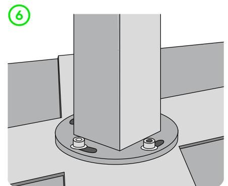
Alle Schrauben fest anziehen und fertig ist die Montage des Mastes.
