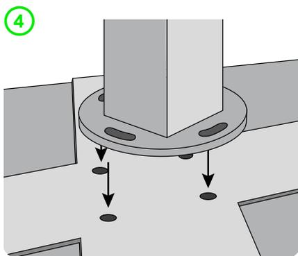
Stellen Sie den Mast mit dem Flansch auf die Bodenhülse oder den mobilen Standfuß.
