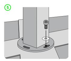
Halten Sie den Mast fest, während eine zweite Person ihn mit dem Standfuß verschraubt. Verwenden Sie zum Verschrauben **nur die mitgelieferten** 4 Schrauben (M10×35 mm) mit Beilagscheiben.
