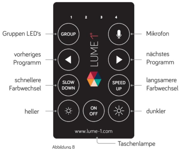
Hinweis: Die Fernbedienung wechselt nach einiger Zeit in den Stromsparmodus. Drücken Sie eine beliebige Taste der Fernbedienung, um den Stromsparmodus zu beenden.
