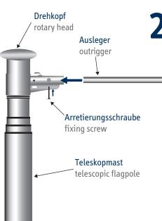
Den Ausleger auf den Drehkopf schieben und mit der Schraube arretieren.
