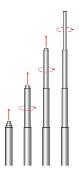
Ziehen Sie den Teleskopmast aus und drehen Sie jedes Element im Uhrzeigersinn fest. Fertig.
