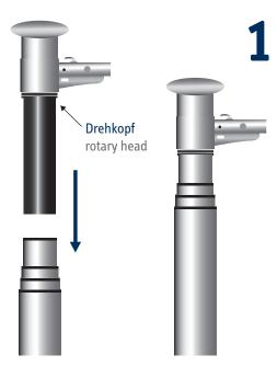
**Achtung!** Den Auslegerarm, der sich <u>im</u> Teleskopmast befindet, unbedingt vorher herausnehmen und danach den Drehkopf auf den Teleskopmast aufklopfen.
